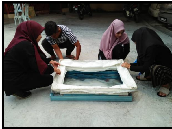
Rajah 24 : Pemasangan selimut api pada bingkai.
