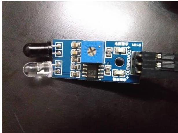
Diagram 3.5.2.1 Infrared Sensor
