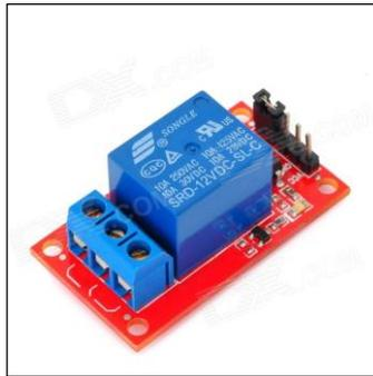
Diagram 2.2.7.1 Relay 1 CH 12V
