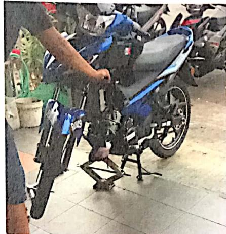
Kami menggunakan konsep yang sama iaitu untuk meninggikan motorsikal tetapi ia digunakan untuk di bahagian hadapan. Terdapat besi yang berfungsi untuk menahan fork hadapan. Kami menginovasikan supaya peninggi motorsikal ini dipindahkan tempat supaya berada dihadapan supaya boleh digunakan dengan kadar segera. Konsep ini juga dapat menambahkan ketabilan motosikal ketika tayar depan dibuka.
