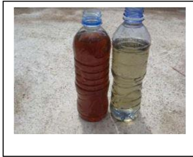
Rajah 4 : Hasil sisa efluen sebelum dirawat (kiri) dan selepas dirawat (kanan)
