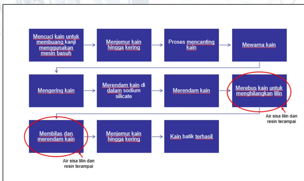
Carta 1 : Proses Pembuatan Batik di Kilang Master Wan Batik
