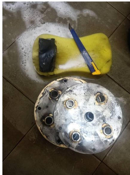
Rajah 3. 4 Plat Besi Telah Dipotong
