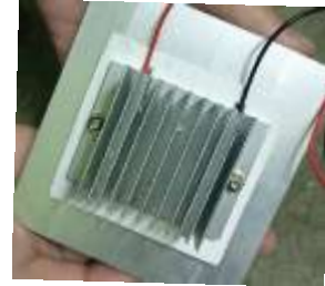
3. Skru heat sink di bahagian bawah peltier.
