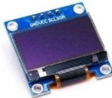
Figure 3.3: OLED display module
