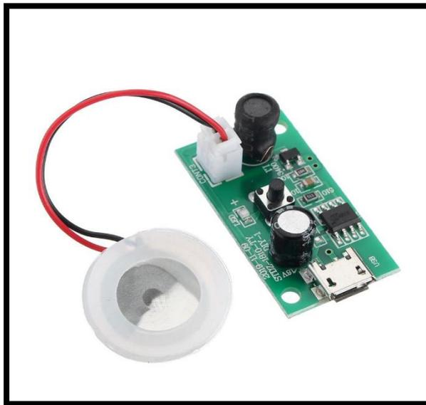
**FIGURE 3.5 : Spray module 5v 108khz**
