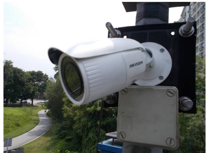
Rajah 4.2.3 iii IP kamera yang digunakan bagi memantau kejadian banjir
