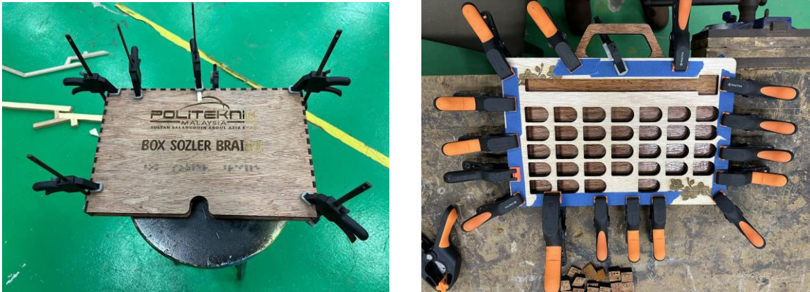
Figure 3.6 (d) : Clamp the wood pieces
