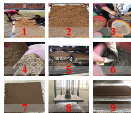
Rajah 2: Gambar turutan proses pembuatan papan partikel terikat simen (CBPB)
