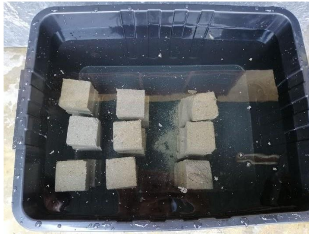
Rajah 3.3: Ujian peyerapan air dibuat di makmal konkrit Politeknik Shah Alam.
