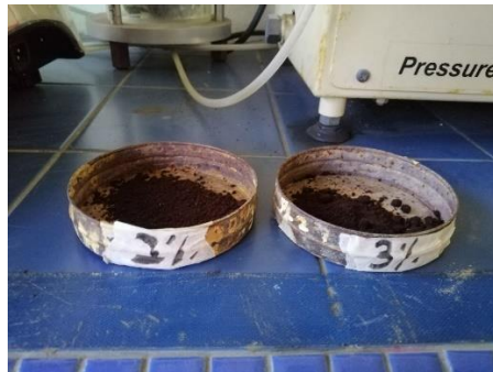
Rajah 3.9 menunjukkan moisture content can yang mengandungi abu kulit pisang yang telah ditimbang.
