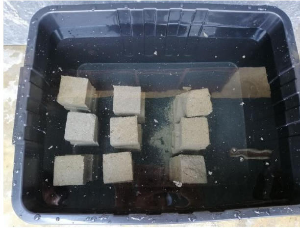
Rajah 2.3: Ujian serapan air yang dibuat di makmal konkrit Politeknik Shah Alam.
