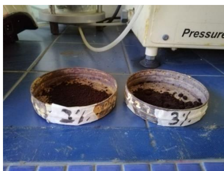
Rajah 3.4.2 menunjukkan moisture content can yang mengandungi abu kulit pisang yang telah ditimbang.
